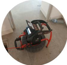
La tête de caméra émet une fréquence détectable à l'aide d'un récepteur d'onde.
