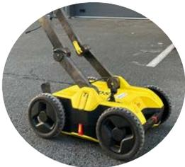
Permet une détection des éléments enterrés traditionnellement non détectable tels que : canalisations non métalliques y compris en :
