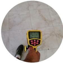
de la canalisation d'alimentation général à partir du compteur d'eau : un émetteur transmet une fréquence électrique à la canalisation si elle est métallique, ou d'une sonde émettrice. On détecte ensuite cette fréquence à l'aide de notre récepteur.
